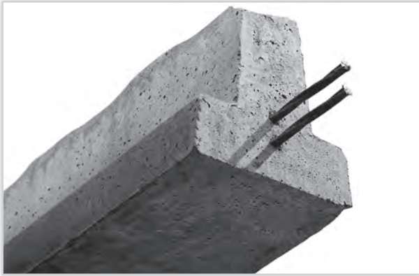
Belki 110-130. Materiał: beton C 50/60. Zbrojenie: stal klasy 2060 MPa. Wymiary (dł./wys./szer.) [mm]: 1-10/110-130/98-105. Rozstaw osiowy [mm]: od 59 do 60.
