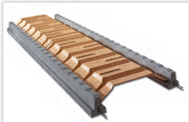
Rectolight. Wypełnienie: panele stropowe z drewna prasowanego. Długość elementu: 120 cm, zastępuje 6 pustaków. Wysokość stropu [cm]: od 16 do 26. Masa: 1 m 2 stropu od 190 kg. Klasyfikacja ogniowa: REI 60. Stosowany we wszelkich budynkach mieszkalnych i użyteczności publicznej, z zastosowaniem sufitów podwieszanych. Uzyskiwane rozpiętości w systemie Rectolight wahają się między 1,8 m do ponad 8,0 m. Łatwość w cięciu i wykonywaniu otworów sprawia, iż jest dopasowany do każdego projektu. Konstrukcja stropu może uzyskać ognioodporność REI 60 (Badanie ITB nr 28818/11/Z00 NP).
