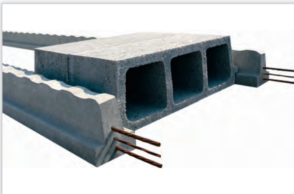
Rectobeton – wypełnienie pustaki z czystego betonu. Wysokość całkowita stropu [cm]: od 14 do 340. Masa: 1 m 2 stropu od 235 kg. Klasyfikacja ogniowa: od REI 60 do REI 240. Stosowany we wszystkich rodzajach budynków, na wszystkich kondygnacjach uzupełnieniem systemu są: zbrojenia przypodporowe, zgrzewane maty siatki stalowej oraz beton monolityczny wylewany na budowie.
